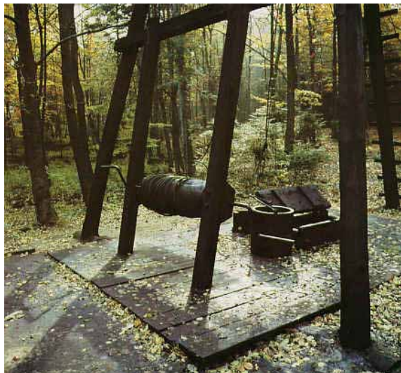
Ryc. 1. Kopanka Franek z 1860 roku; zabezpieczona studnia kopana w celu poszukiwania i eksploatacji ropy; Skansen Muzeum Przemysłu Naftowego im. Ignacego Łukasiewicza w Bóbrce k/Krosna (źródło: opracowanie własne)
